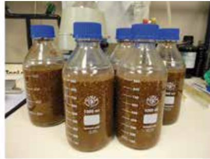
Prehidrólisis ácida 3% H_2SO_4 , liq: sol 8:1 (g/g) 130 °C, 15 min
