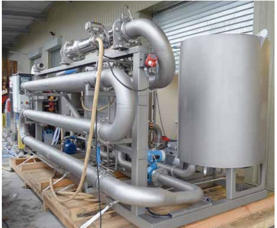
Filtre tangential à membrane en acier inoxydable. F. Davaux
